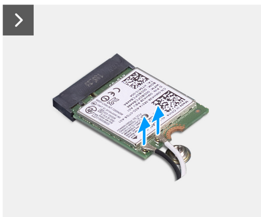
Ilustración 15. Extracción de la tarjeta inalámbrica
