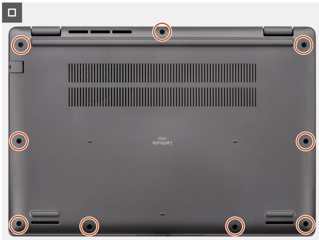
Ilustración 12. Instalación de la cubierta de la base
