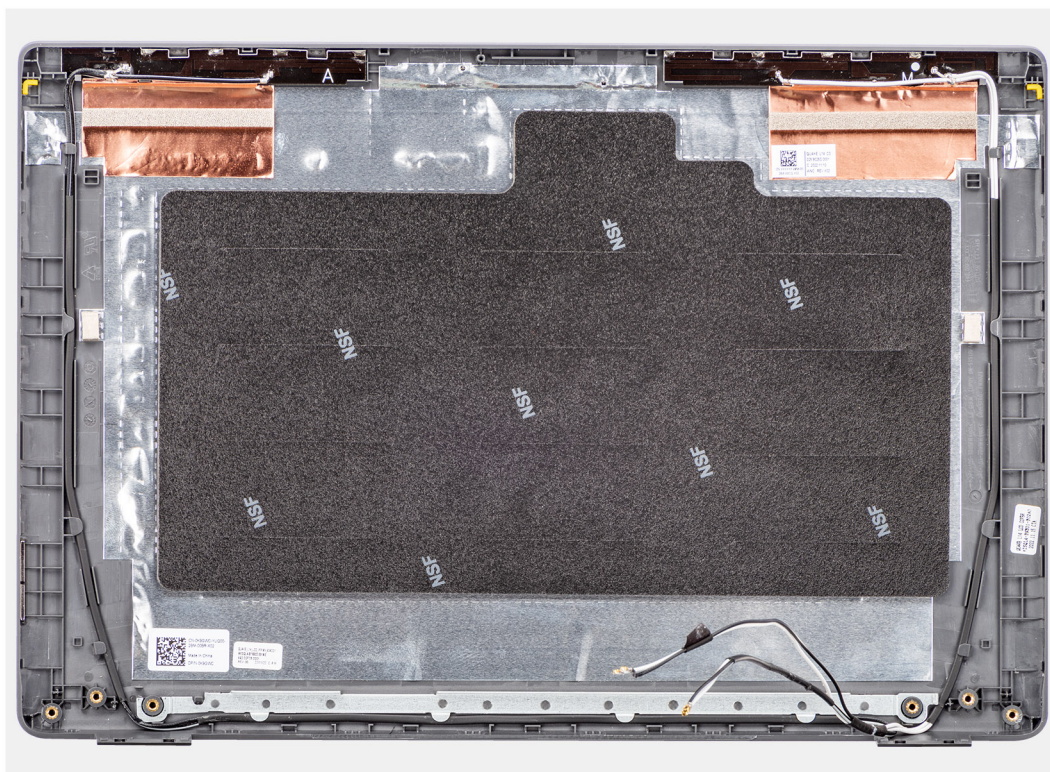
Ilustración 69. Extracción de la cubierta posterior de la pantalla
