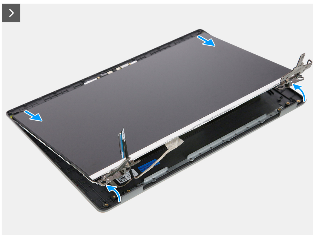
Ilustración 56. Extracción del panel de pantalla
